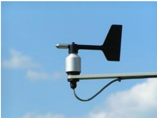
Windfahne (= Windrichtungsgeber) Stefan Kühn, CC BY-SA
