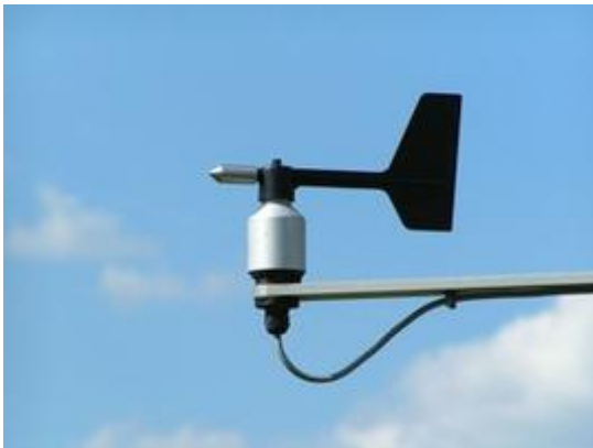
Windfahne (= Windrichtungsgeber) Stefan Kühn, CC BY-SA
