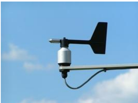
Windfahne (= Windrichtungsgeber) Stefan Kühn, CC BY-SA
