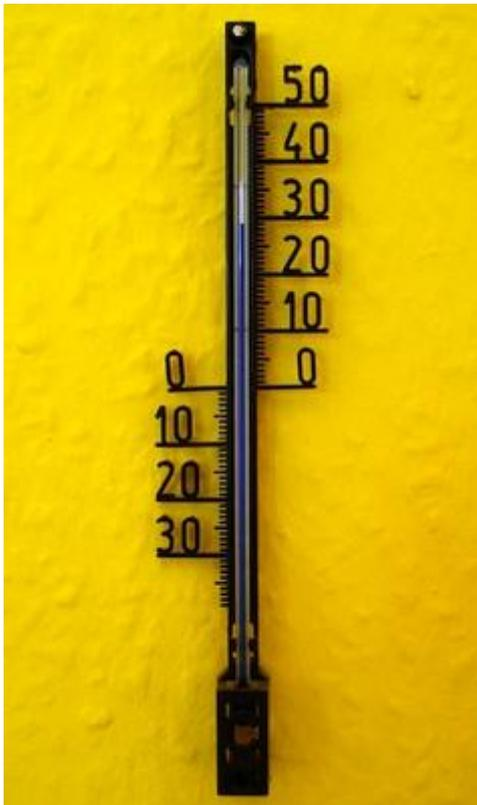
Im Haushalt gebräuchliches Flüssigkeitsthermometer. In dem Gehäuse befindet sich ein Glasrohr, in dem eine gefärbte Flüssigkeit aufsteigen kann.
