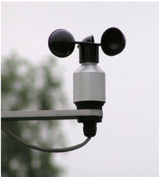
Anemometer, ein Messgerät für die Windgeschwindigkeit Bundesarchiv , CC BY-SA
