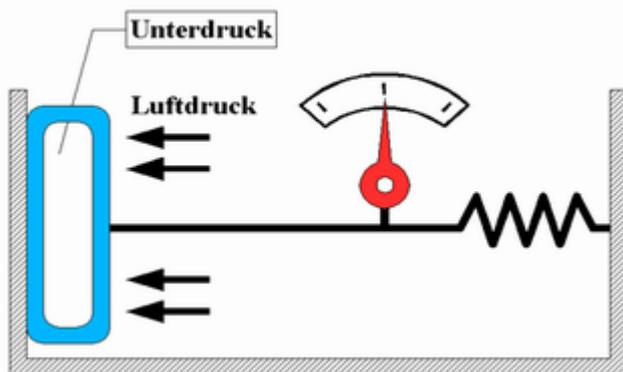
Funktionsprinzip eines Dosenbarometers
