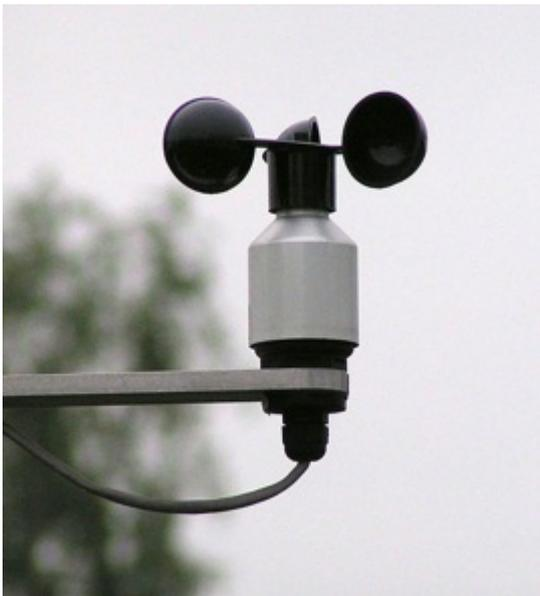
Anemometer, ein Messgerät für die Windgeschwindigkeit
