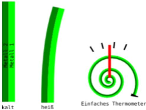
Messprinzip eines Bimetall-Thermometers. Das dunkelgrün dargestellte Metall auf der linken Seite dehnt sich bei Temperaturänderung stärker aus als das hellgrün dargestellte rechts. Dadurch verbiegt sich bei einer Temperaturänderung der Bimetall-Streifen
