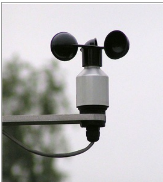
Abb. 6: Anemometer, ein Messgerät für die Windgeschwindigkeit
