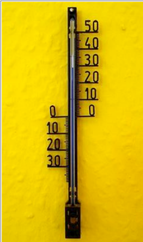
Abb. 1: Im Haushalt gebräuchliches Flüssigkeitsthermometer. In dem Gehäuse befindet sich ein Glasrohr, in dem eine gefärbte Flüssigkeit aufsteigen kann.
