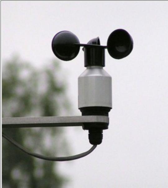
Abb. 6: Anemometer, ein Messgerät für die Windgeschwindigkeit
