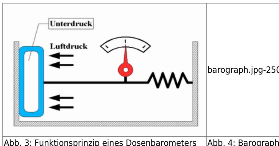
Abb. 3: Funktionsprinzip eines Dosenbarometers
