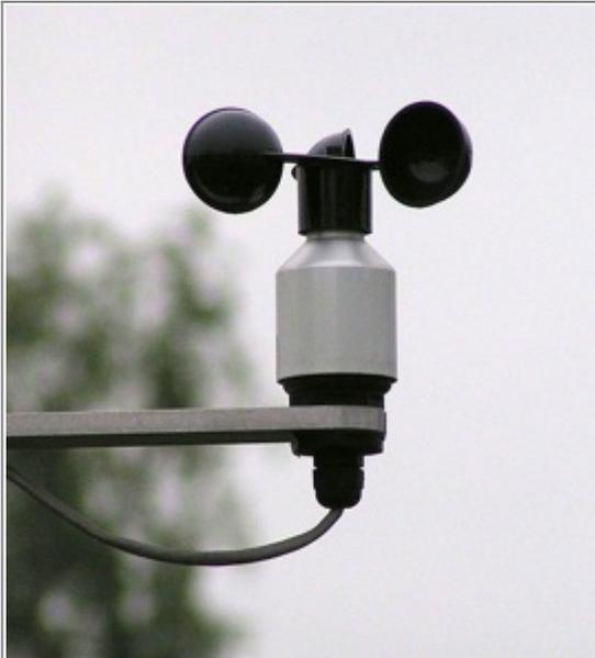
Abb. 6: Anemometer, ein Messgerät für die Windgeschwindigkeit
