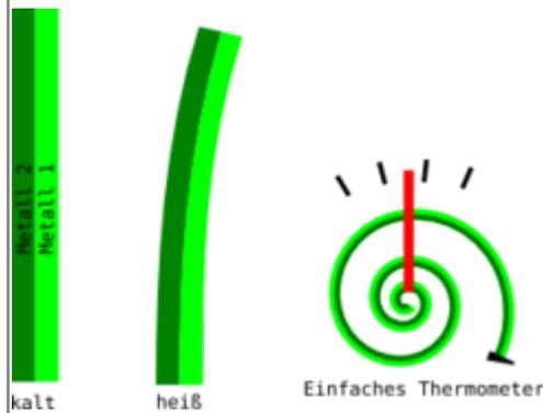
Abb. 2: Messprinzip eines Bimetall-Thermometers. Das dunkelgrün dargestellte Metall auf der linken Seite dehnt sich bei Temperaturänderung stärker aus als das hellgrün dargestellte rechts. Dadurch verbiegt sich bei einer Temperaturänderung der Bimetall-Streifen
