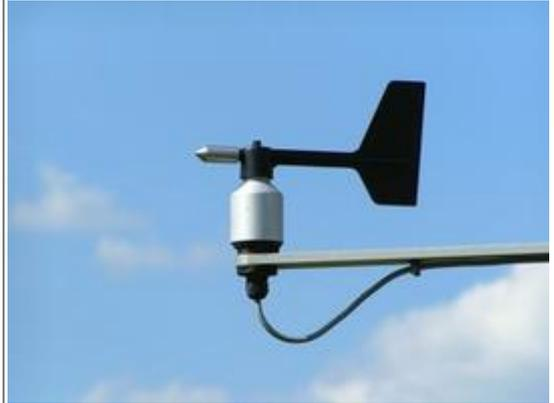
Abb. 7: Windfahne (= Windrichtungsgeber)
