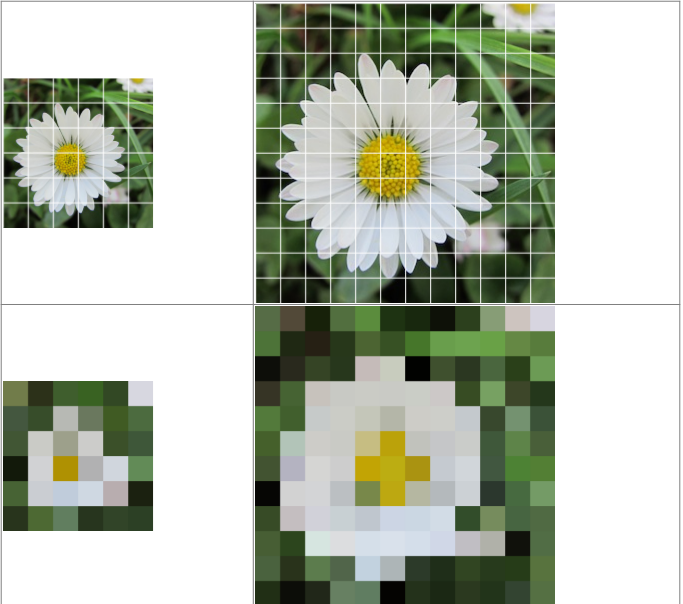
Abb. 3: Das selbe Motiv kann mit unterschiedlich vielen Pixeln abgebildet werden. Je mehr Pixel vorhanden sind, desto klarer wird das Motiv dargestellt – und desto mehr Speicherplatz braucht die Bilddatei, weil mehr Farbinformationen gespeichert werden müssen.
