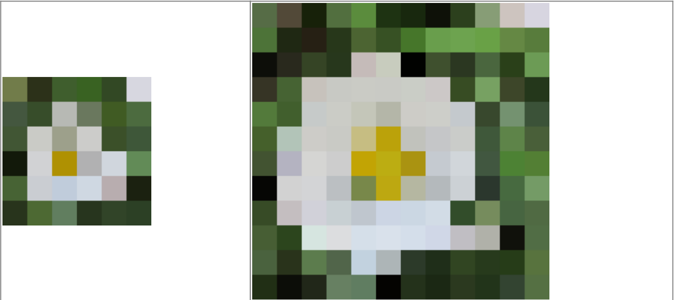
Abb. 3: Das selbe Motiv kann mit unterschiedlich vielen Pixeln abgebildet werden. Je mehr Pixel vorhanden sind, desto klarer wird das Motiv dargestellt – und desto mehr Speicherplatz braucht die Bilddatei, weil mehr Farbinformationen gespeichert werden müssen.
