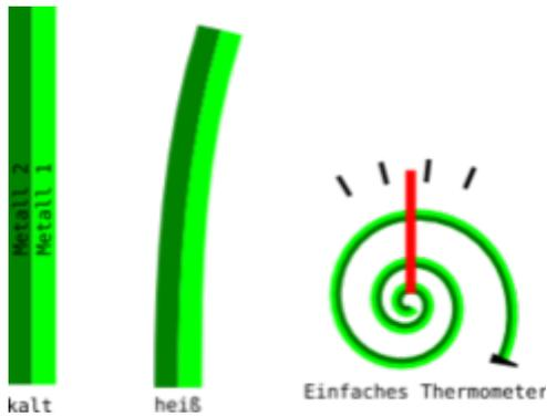
Messprinzip eines Bimetall-Thermometers. Das dunkelgrün dargestellte Metall auf der linken Seite dehnt sich bei Temperaturänderung stärker aus als das hellgrün darstellte rechts. Dadurch verbiegt sich bei einer Temperaturänderung der Bimetall-Streifen
