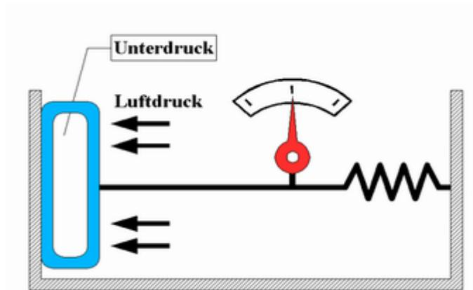
Funktionsprinzip eines Dosenbarometers
