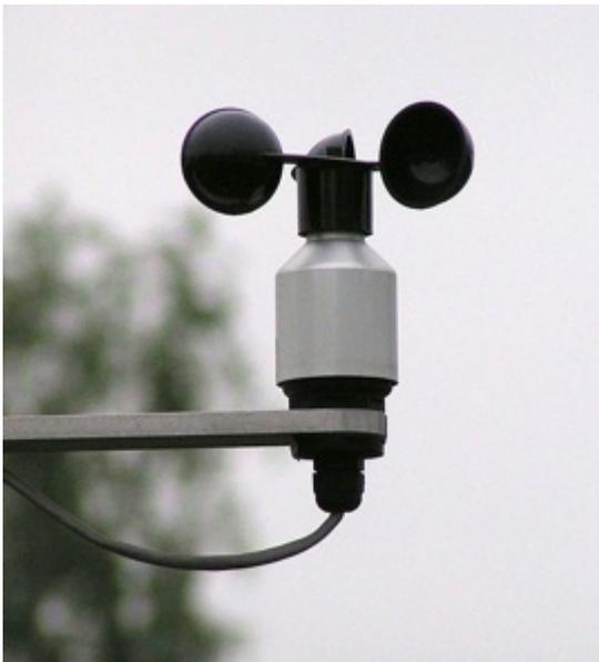
Anemometer, ein Messgerät für die Windgeschwindigkeit
