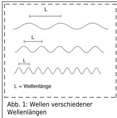
Eine wichtige Eigenschaft elektromagnetischer Wellen ist ihre Wellenlänge (L). Die Wellenlänge bezeichnet den Abstand von einem Wellenberg zum nächsten (siehe Abb. 1). In der Natur kommen Wellen unterschiedlichster Wellenlängen vor, so dass uns ein kontinuierliches Spektrum elektromagnetischer Wellen umgibt (siehe Abb. 2). Röntgenstrahlen und Radiowellen gehören ebenso dazu wie Mikrowellen und das sichtbare Licht.
